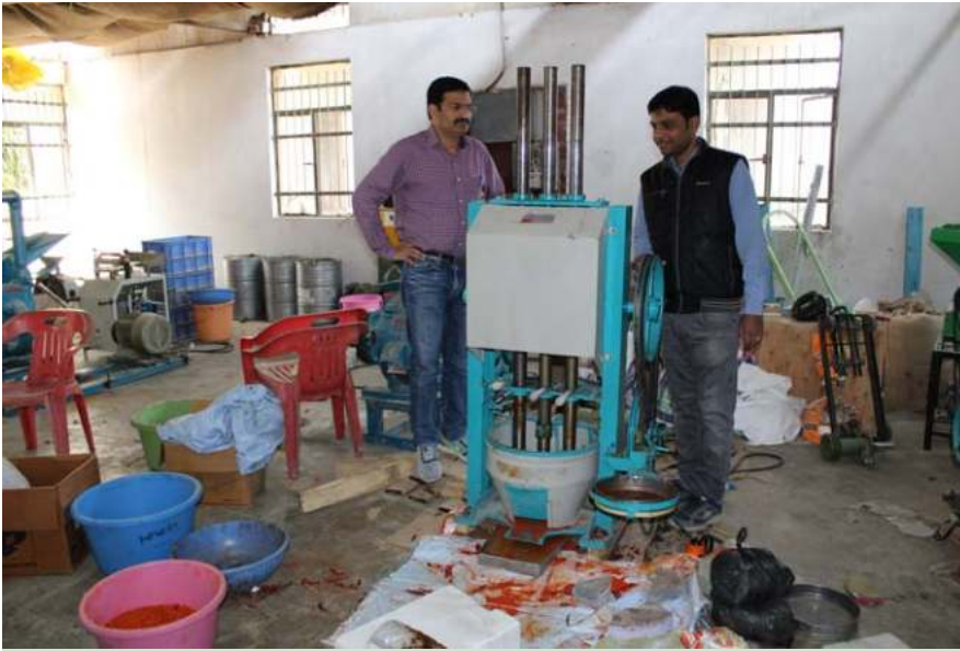
चित्र 2: मिर्च पाउंडिंग मशीन का परीक्षण
