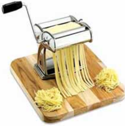
चित्र 1. (अ) पास्ता बनाने की हस्त संचालित मशीन (ख) पास्ता बनाने की बर्हिर्वर्धन मशीन
