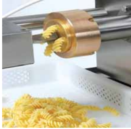
चित्र 1. (अ) पास्ता बनाने की हस्त संचालित मशीन (ख) पास्ता बनाने की बर्हिर्वर्धन मशीन
