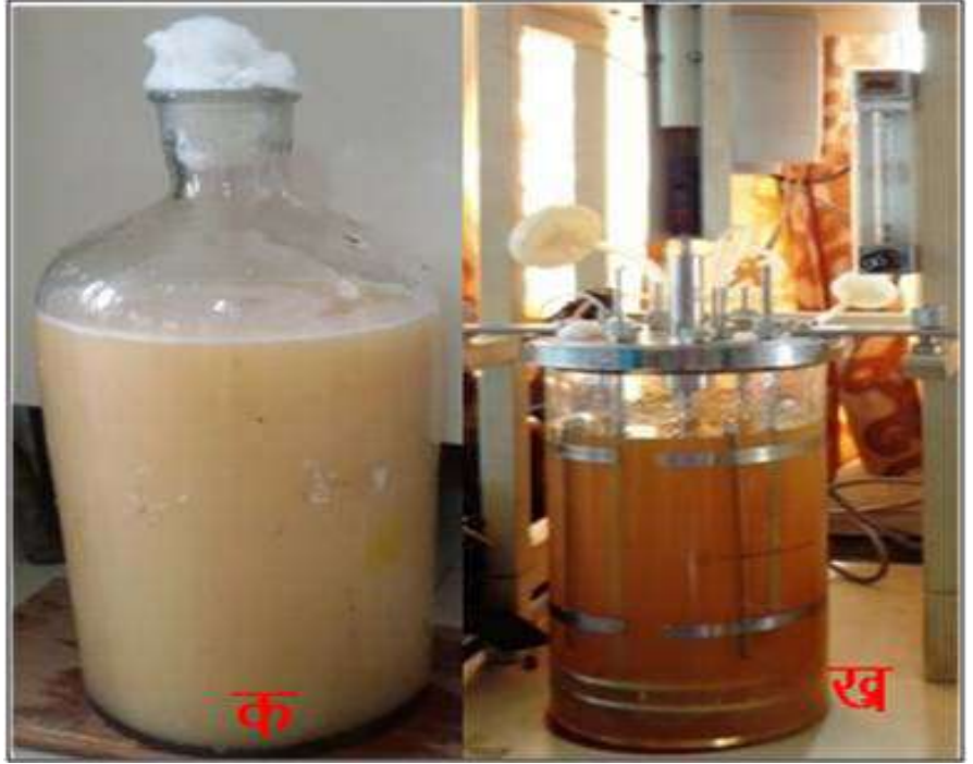
रस का अल्कोहलिक किण्वीकरण (क) प्राकृतिक किण्वीकरण (ख) फरमेन्टर द्वारा किण्वीकरण
