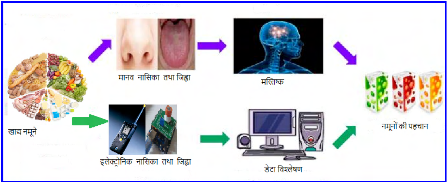
चित्र 4: इलेक्ट्रॉनिक नासिका तथा इलेक्ट्रॉनिक जिह्वा द्वारा नमूना विश्लेषण की कार्य प्रणाली
