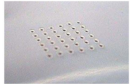
चित्र 6: लेजर का उपयोग करके पैकेजिंग फिल्म पर किए गए छिद्र
