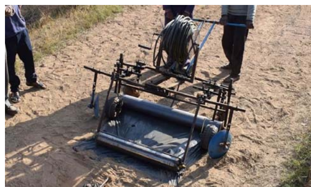
Fig. 58. Mulch laying cum retival machine
